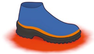
■ Figure 19. Le semelage isolant contre la chaleur
