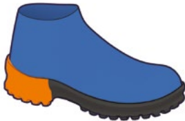
■ Figure 10. Le talon absorbeur d'énergie
