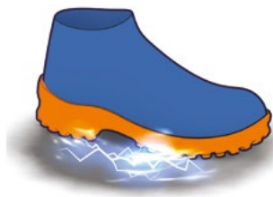
■ Figure 17. Le semelage contre les risques électriques
